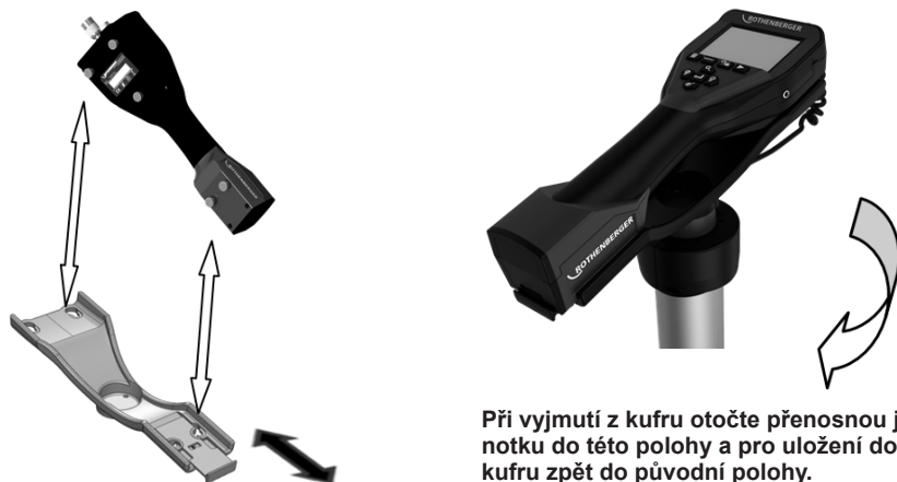
Obrázek 4 - Instalace přenosné jednotky ROSCOPE 1000/i2000 na montážní kolébku
