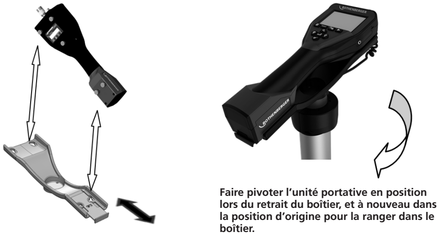
Figure 4 - Installation de l'unité de poing ROSCOPE 1000/i2000 dans le réceptacle de montage.
