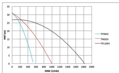
Ces séries TP sont adaptées aux transferts d'eaux claires et moyennement chargées en acceptant des particules allant jusqu'à 7.5 mm. Le groupe motopompe TP110EX est équipé de moteur professionnel EX WORMS haute performance. Des matériaux de hautes performances tels que la garniture mécanique en carbone céramique et le corps de pompe en fonte d'aluminium moulé injectée sous pression offrent une excellente fiabilité et longévité.
