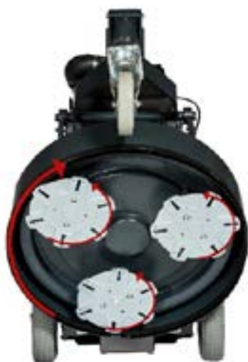
Figur 4-1 Illustrerar sliphuvudernas rotation i förhållande till det nedre huset.
