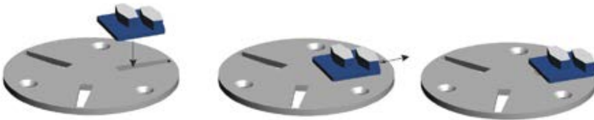
Figur 4-3 Montering av diamantsegment på Scan-On-skivan.
